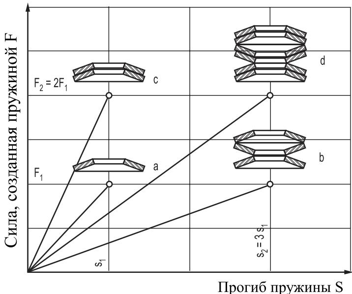
Конусная форма тарельчатых пружин позволяет складывать отдельные пружины в блоки. При этом меняется характеристика пружины в соответствии с необходимыми требованиями.
